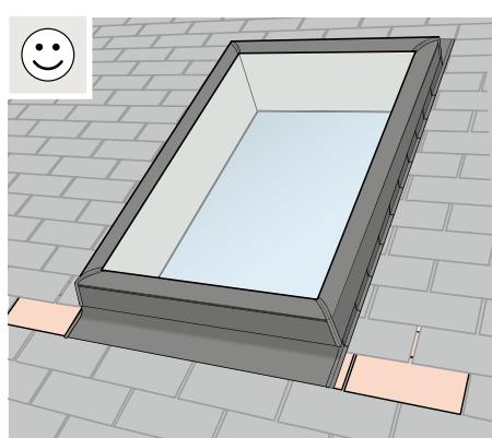
**FRANÇAIS :** Pour une meilleure apparence, les coins de solin d'appui et de solin en sabot exposés peuvent devoir être recouverts d'un bardage de finition.
