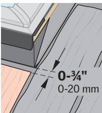
**FRANÇAIS :** Installer une rangée de bardeaux de cèdre coupés sous le puits de lumière ou la fenêtre de toit. Respecter la distance au cadre, tel qu'ilustré.
